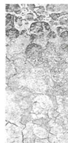
Membrana BIT-SBS dopo 500 cicli
